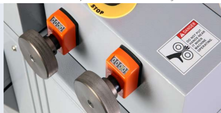
Molettes d'ajustement des rouleaux de vernissage
